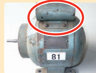
単相モーターに取り付けられた低圧コンデンサー
