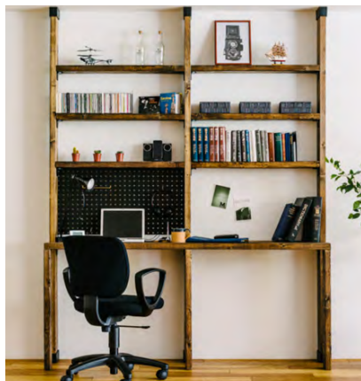
壁や天井に穴をあけずに施工ができるディアウォールシリーズ 出典:ディアウォール® (DIAWALL) ウェブサイト
