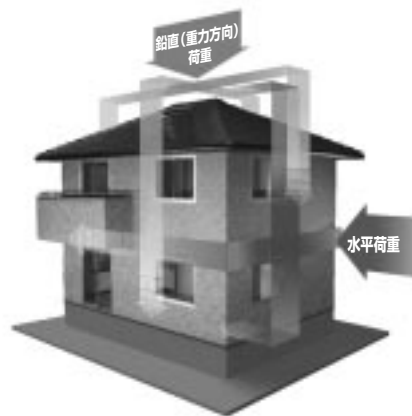
図4:「等級3」をクリアした大型パネル構造
