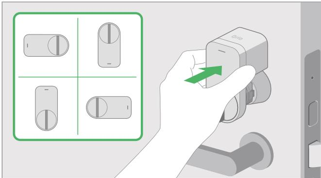
スマートロックが取り付けられるスペースを確保します。縦・横・上向き・下向きにお取り付けできます。また、取り付け面が水平であることを確認してください。
